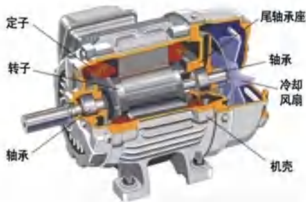
图表：直流电机结构示意图
