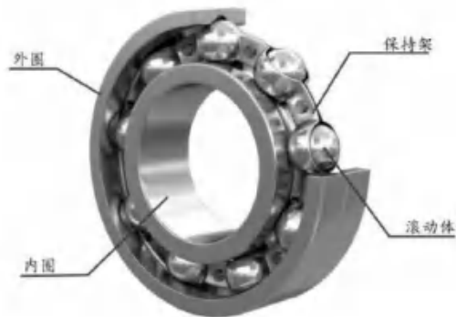
图表：滚动轴承结构示意图
