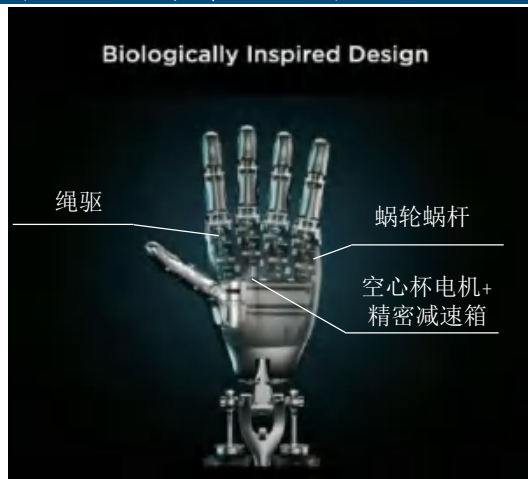
图表：特斯拉机器人手部使用12个执行器（6*2）
