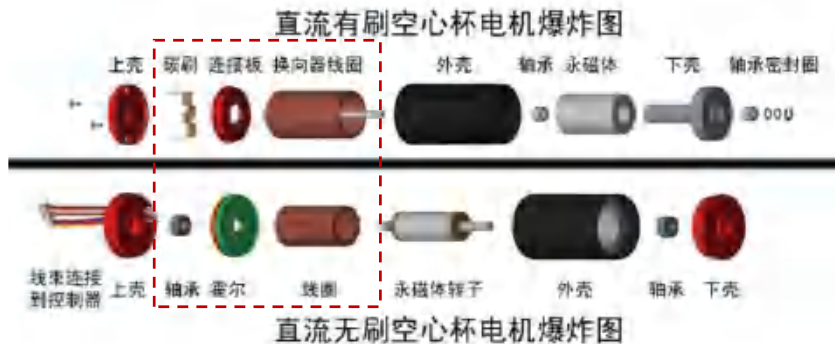
图表：有刷空心杯电机和无刷空心杯电机结构
