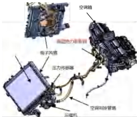
图表：燃油车空凋制冷（冷媒）回路产品架构
