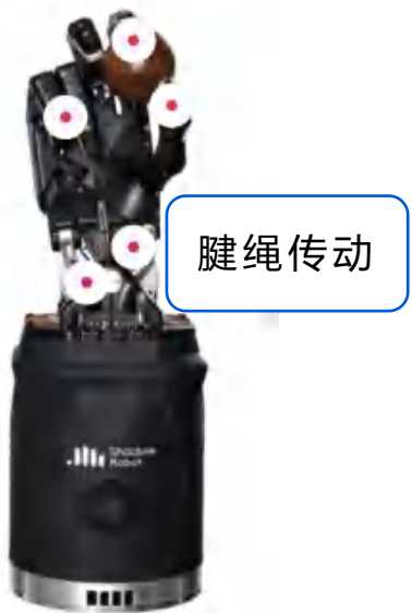
图表：采用腱绳传动方式的一种灵巧手
