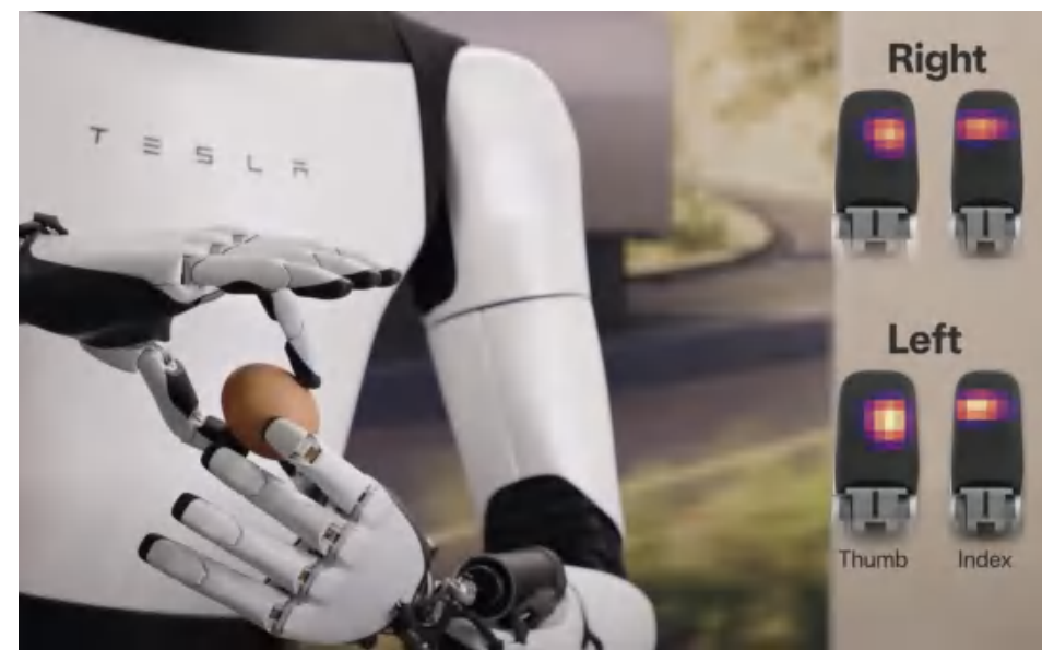
图表：Optimus的每只手指均配备柔性触觉传感器
