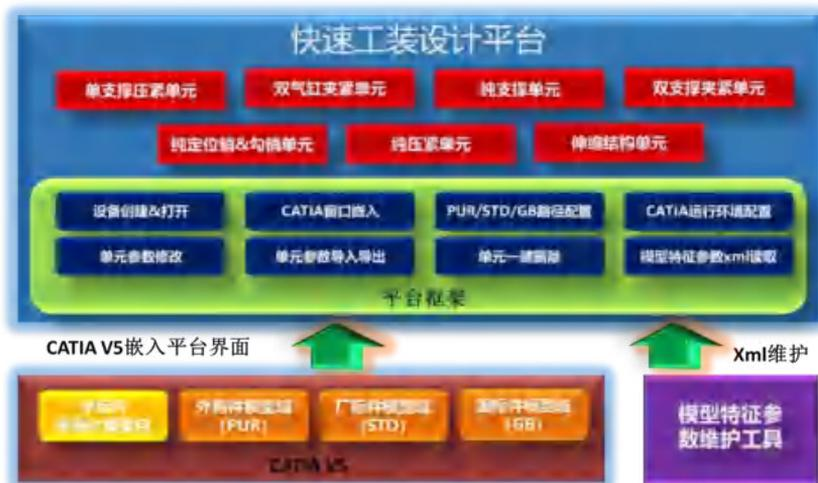
图 29 快速工装设计平台架构图
