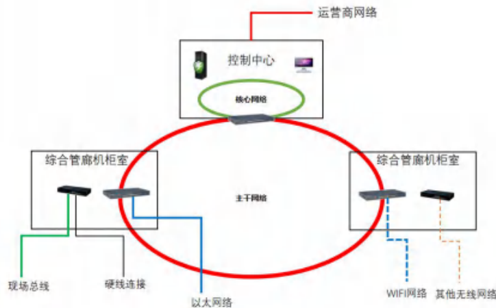
图 B-1 综合管廊物联网网络架构
