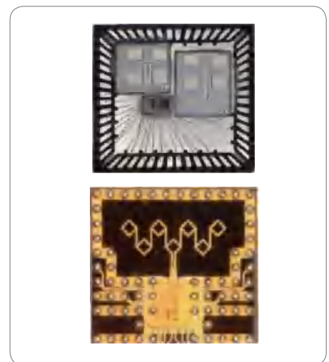
图 3-17 基于框架和圆片级扇出封装的 AiP 应用
