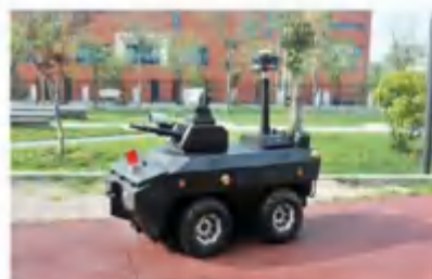
安防巡检机器人
