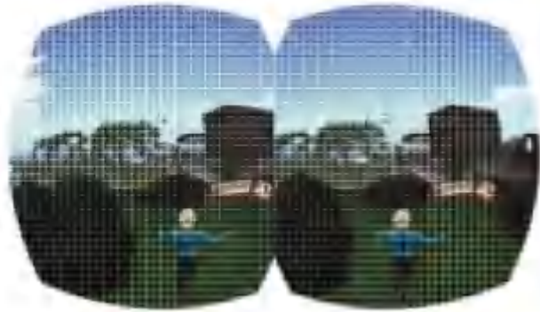
图 14 显示屏“纱窗效应”示意图
