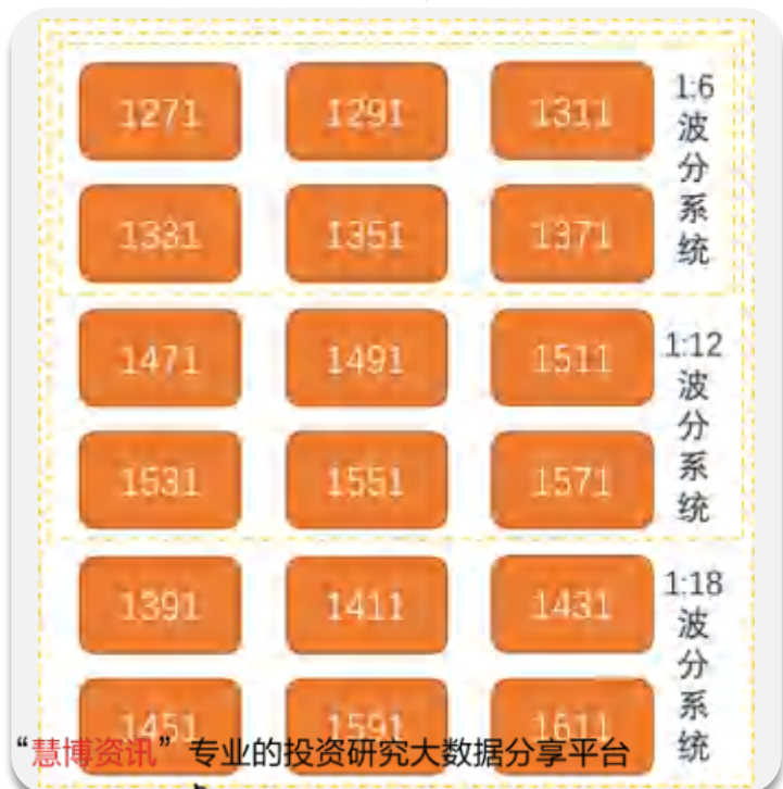
图：CWDM无源波分的波长使用情况
