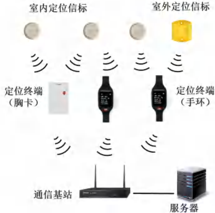
图 3.4-2 蓝牙终端测量定位网络架构
