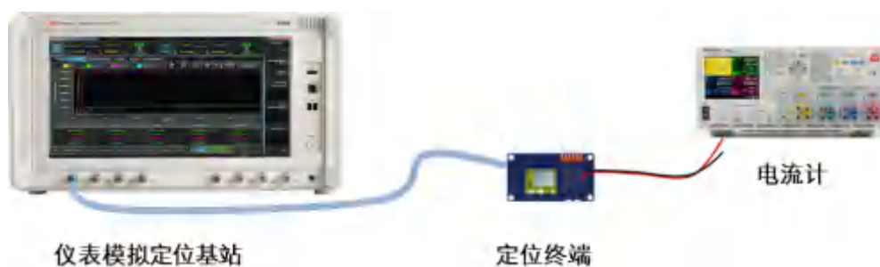
图 4.2-5 基于仪表的定位终端功耗测试系统示意图
